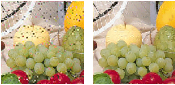
a) Image WTSOM reçue après CCE f_D T_s = 3,5e-4 , SNR=15dB TEB=5%, PSNR=21.05dB b) Image WTSOM reçue après restauration PSNR = 24,41dB
